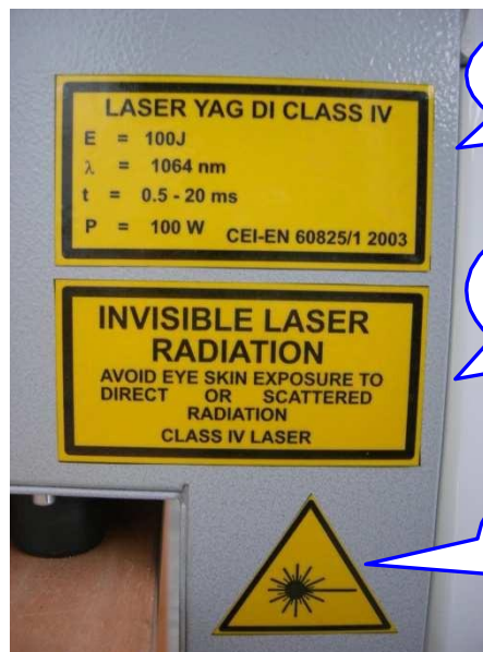
Рисунок 1: Предупреждающие таблички, расположенные сзади аппарата
